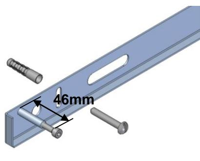
Die beiden Innensechskant-Schrauben auf das vorgegebene Mass (46mm) drehen.
