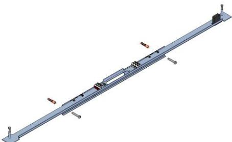
Befestigung Wandschiene mit Collisions Micro Switch mittels den beigelegten Dübeln an einer zur Montage geeigneten Wand.
