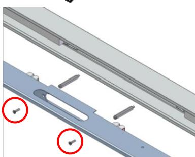
Lift the mounting rail and screw the luminaire and the mounting rail with the enclosed flat head screw. Leuchte hochklappen und Distanzbolzen mit mitgelieferten Senkkopfschrauben an der Montageschiene befestigen.
