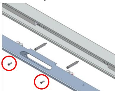
Leuchte hochklappen und Distanzbolzen mit mitgelieferten Senkkopfschrauben an der Montageschiene befestigen.
