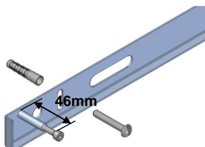
Avvitare le due viti ad esagono cavo alla distanza riportata (46mm)..
