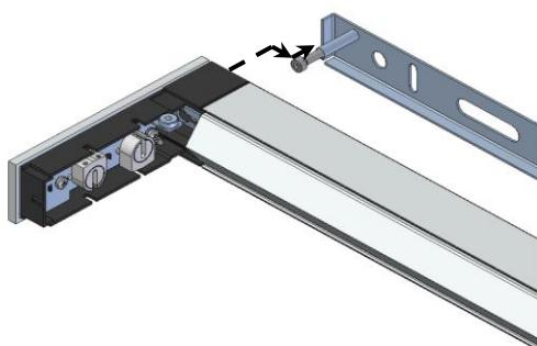
Beide Senkkopfschrauben oben an der Prismenabdeckung lösen. Prismenabdeckung entfernen, Leuchtmittel entfernen und Leuchte gemäss Bild einhängen.
