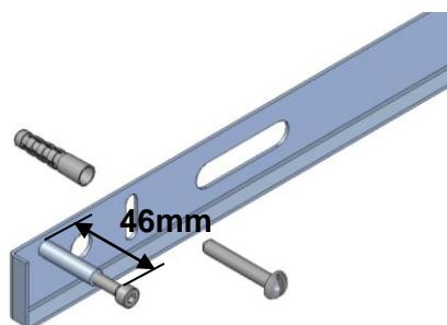
Avvitare le due viti ad esagono cavo alla distanza riportata (46mm).
