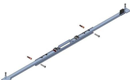
Fixation de la platine murale à l'aide des Collisions Micro Switch fournis à un mur pouvant recevoir la lampe.
