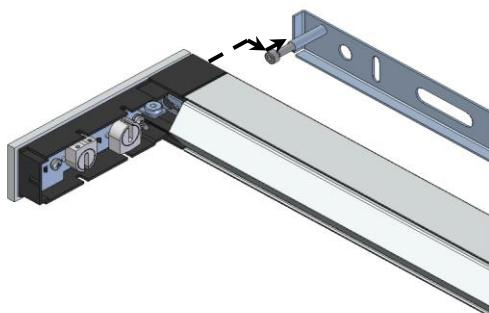
Svitare le due viti a testa svasata in alto sul diffusore. Togliere il diffusore, la lampadina e appendere la lampada come riportato nel disegno..
