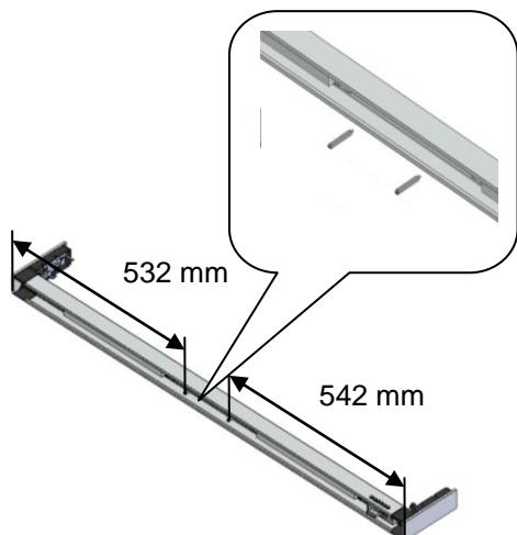
Fixer les boulons d'écartement d'après le plan dans la rainure centrale de la lampe.
