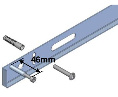
Avvitare le due viti ad esagono cavo alla distanza riportata (46mm).
