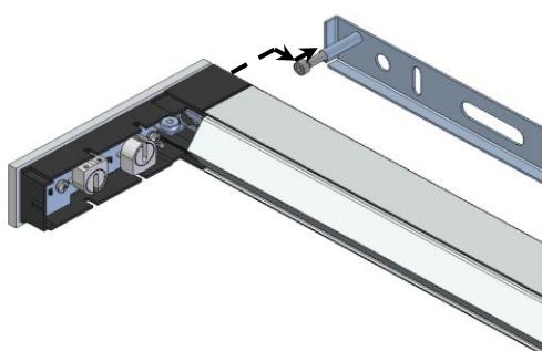
Desserrer les deux vis à tête noyée situées sur la partie supérieure du réflecteur de la lampe. Enlever le réflecteur et les sources lumineuses, puis accrocher la lampe comme indiqué sur le croquis ci-contre.
