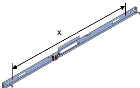
Befestigung der Decken- / Wandschiene mittels den beigelegten Dübeln an einer zur Montage geeigneten Wand.
