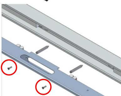
Relever la lampe et fixer les boulons d'écartement à la platine de montage à l'aide des vis à tête noyée fournies.
