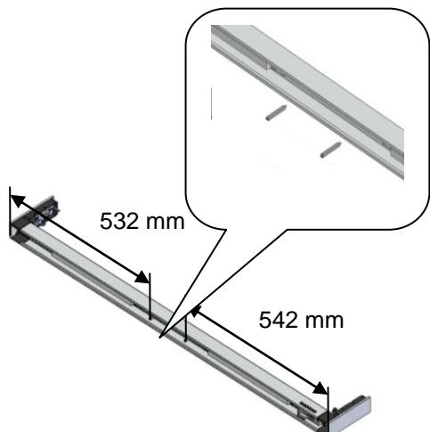
Fissare i perni distanziatori nella scanalatura centrale della lampada come riportato nel disegno
